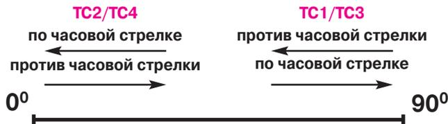
Положение ограничителей устанавливается с помощью шестигранного ключа 2.5 мм.
